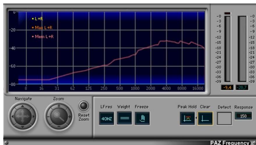
Fig. 16. Respuesta en frecuencia de preamplificador Marshall JCM 800.
