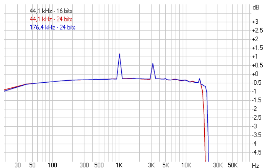
Figura 6. Respuesta en frecuencia de cada configuración durante el proceso de grabación
