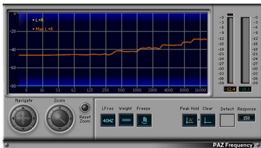
Fig. 14. Respuesta en frecuencia ruido blando en el analizador de espectro.
